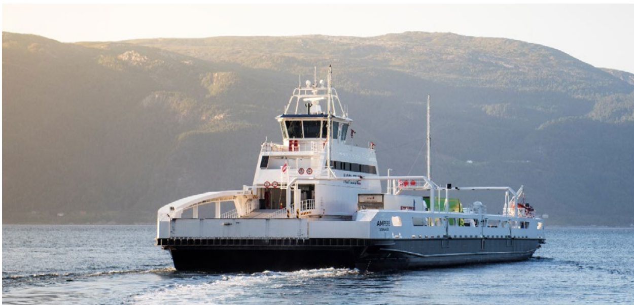
MF «Ampere», verdens første batteridrevne bilferge, har trafikkert fergesambandet mellom Lavik og Oppedal (E39) siden 2015. Den er et resultat av Statens vegvesens krav til nullutslippsløsning ved anskaffelse av ferge for sambandet. Illustrasjon: Enova
