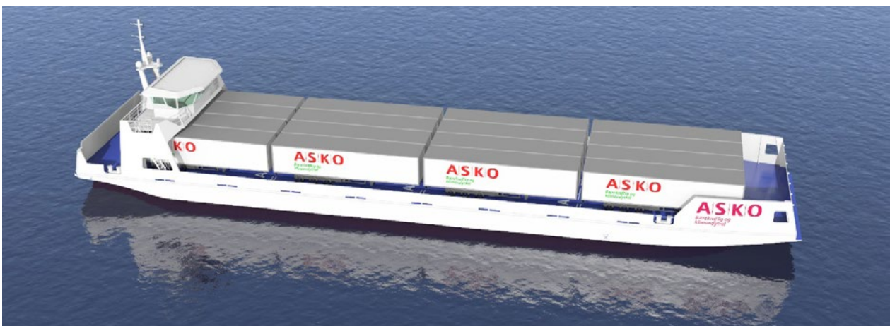
ASKO utvikler autonome, helelektriske fartøy (sjødroner) for containertransport over Oslofjorden. Illustrasjon: Naval Dynamics
