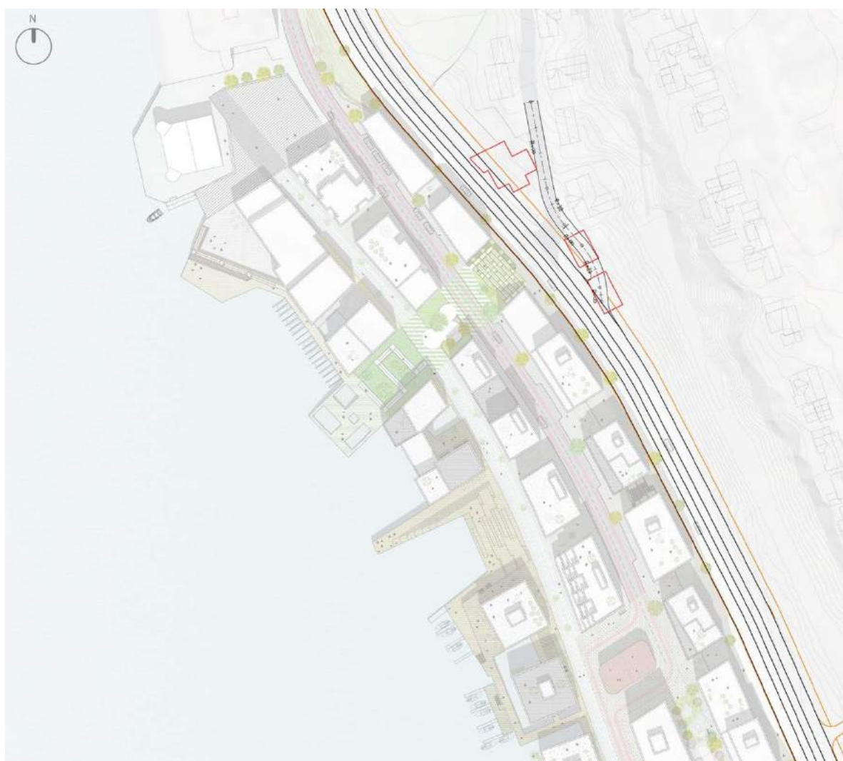
Figur 121_ Plantegning av planforslagets løsning for Fylkesvei 32 med gjennomgående kollektivfelt i begge retninger.
